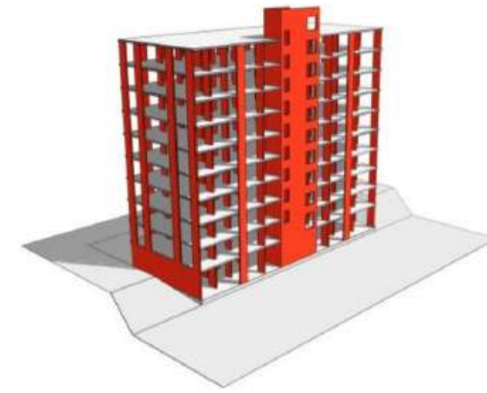
Монолитные ж/б конструкции пилоны+стены ЛЛУ
