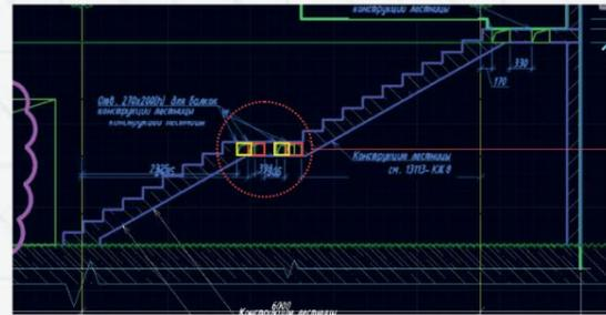
КЮ2 отверстия для балок конструкции лестницы на опалубочных чертежах Ст3 и Ст38 не совпадают
